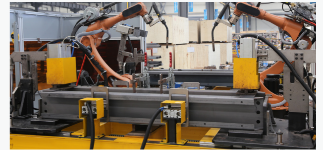
电梯上下梁焊接
