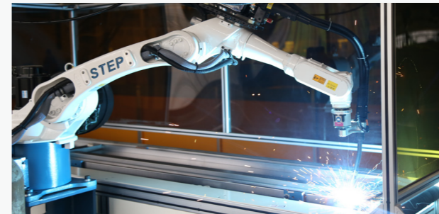
电梯轿厢侧板焊接
